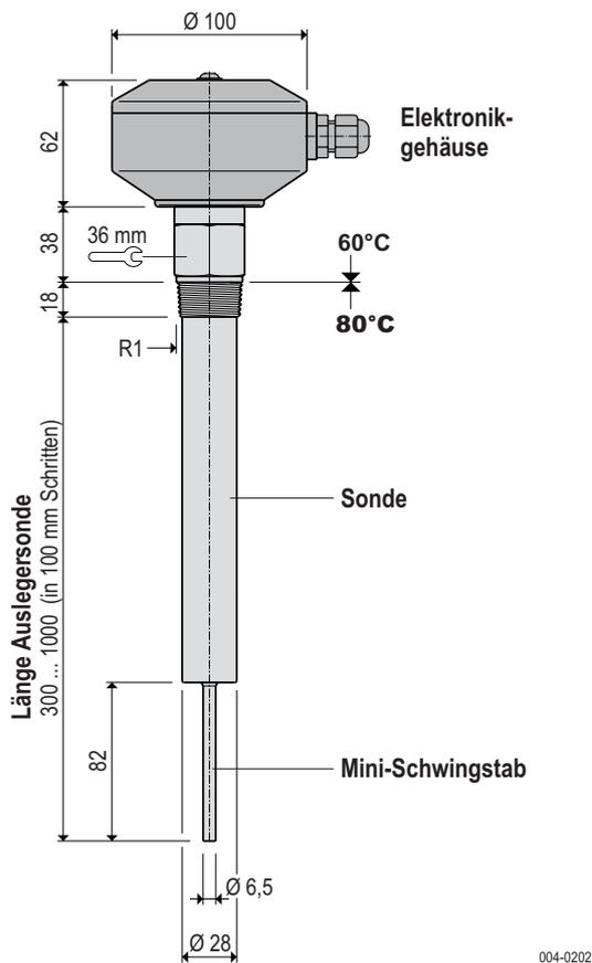
10.3 VF65 Tragkabelsensor
