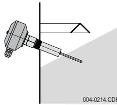
Bei Bedarf im Behälter einen stabilen Abweiser oder ein Schutzdach einbauen, um die Sonde und den Schwingstab vor aufrallendem Schüttgut zu schützen.
