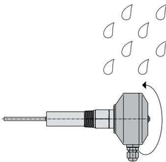
Um das Eindringen von Feuchtigkeit durch die Kabelverschraubungen ins Elektronikgehäuse zu verhindern achten Sie bitte darauf, dass bei eingeschraubtem Füllstandanzeiger die Kabeleinführungen nach unten zeigen.
