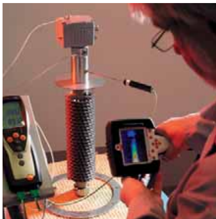
Temperaturüberwachung am Steuerkopf
