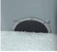
MFE von MOLLET im Einsatz als Leermelder für Kunststoffgranulat
