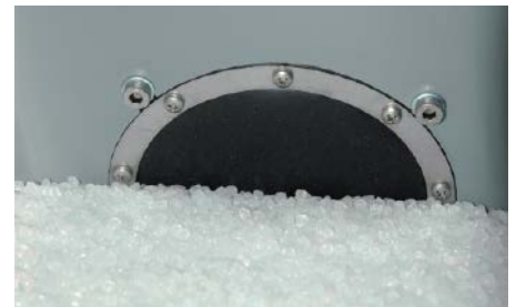
Abb. 4: Molosmembran MFE – Füllstandmessung in Kunststoffgranulat ohne Betriebsenergie
