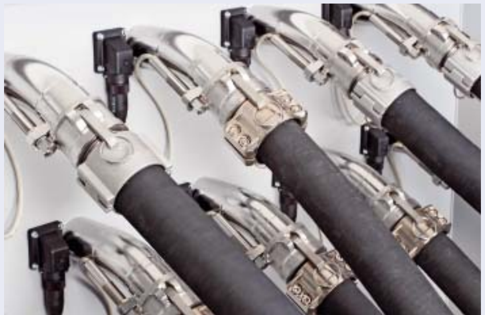
Das RFID-basierte Moloscode-System von Mollet verhindert an Verteilerstationen mögliche Verwechslungen beim Anknüpfen der Schläuche
