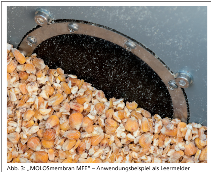
Abb. 3: „MOLOSmembran MFE“ – Anwendungsbeispiel als Leermelder
